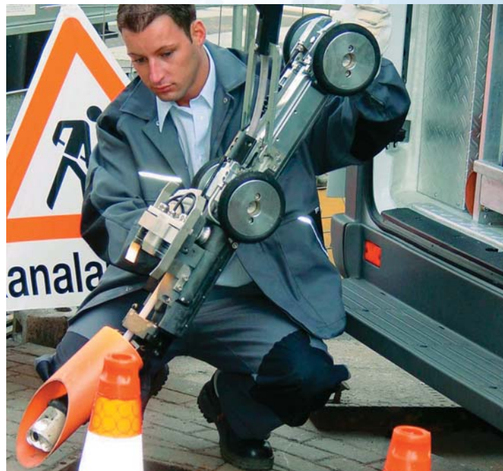
Kanalfernauge im Einsatz, Bild: A. Tombers
