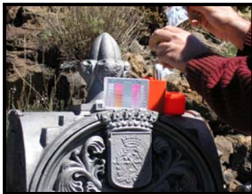
Técnico de Centro realizando la medición diaria de cloro residual libre en un terminal de agua fría de consumo humano.
