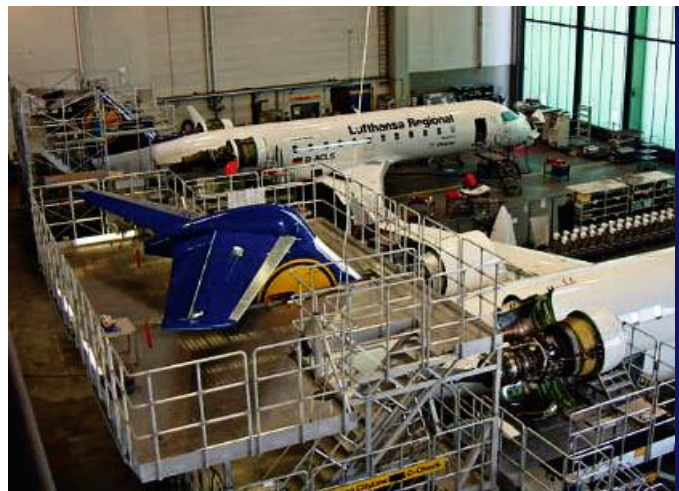
C-Check in der Wartungshalle der CityLine in Köln.
