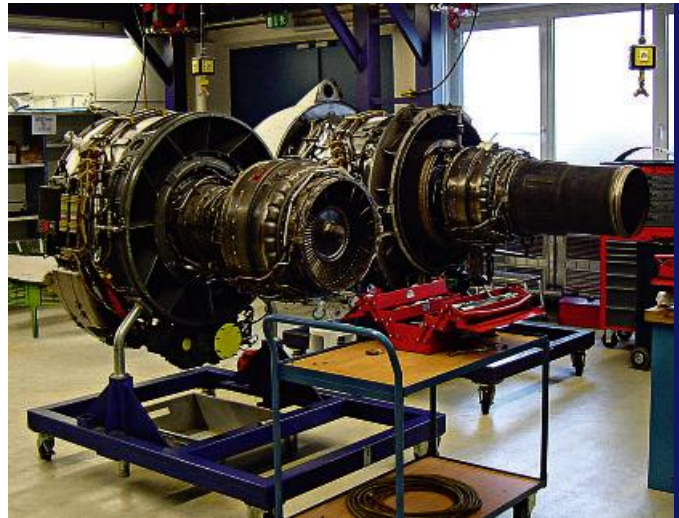
Ausgebaute Triebwerke des Avro RJ85.
