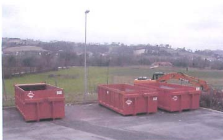
Fig.14 Container scarrabili per messa in riserva dei rifiuti prodotti
