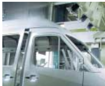
Füllerapplikation mittels elektrostatischer Hochrotationszerstäubung
