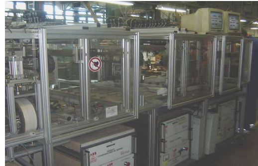
Pupitre de prueba automática de Interruptores Automático Diferenciales
