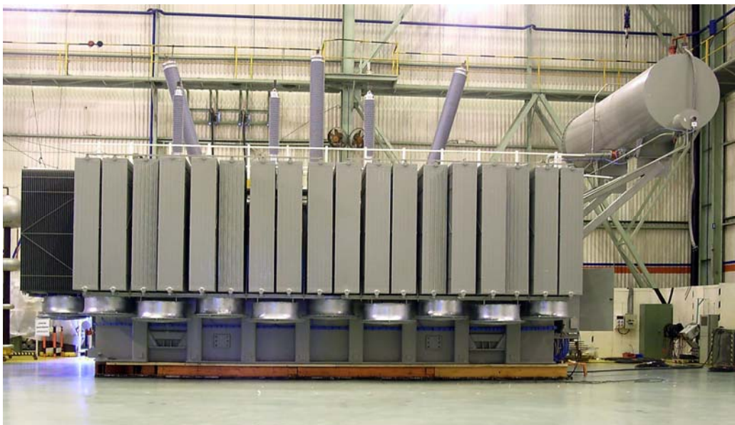
Transformador de Columnas de 450 MVA listo para ensayos
