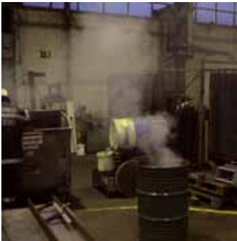
Brandversuch zur Erprobung der Wirksamkeit des Brandmeldesystems: Der heiße Rauch steigt zur Decke empor...
