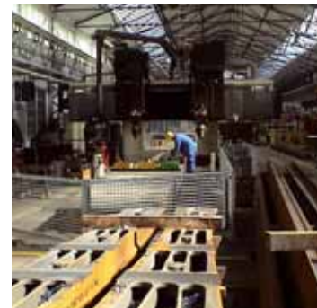
Neues Sicherheitskonzept an Fräsanlage "Waldrich-Coburg"
