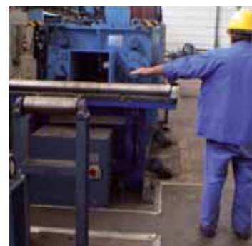
Trittschaltmatten an der Abscheranlage beim Stumpfschweißen
