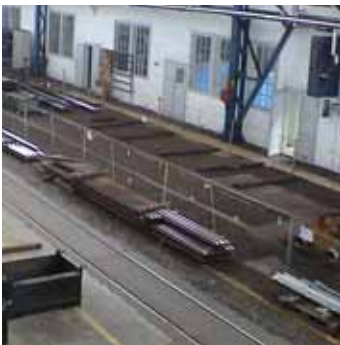
Absicherung des Rückraumes an Hobelmaschine „Billeter“
