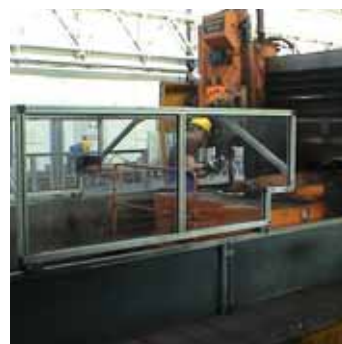
Von Mitarbeitern konzipierte Vorrichtung schützt vor wegschnellenden Spänen
