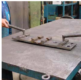
Eine einfache Hebevorrichtung erleichtert das manipulieren von bis zu 35 kg schweren Rippenplatten
