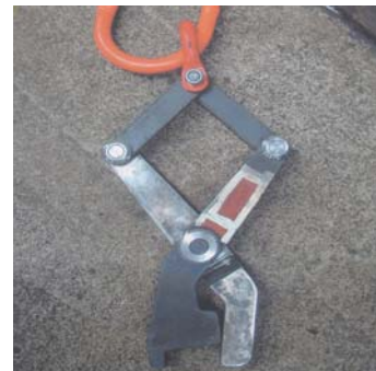
Spezielle Schienenzange zum sicheren Heben von Radlenkerschienen
