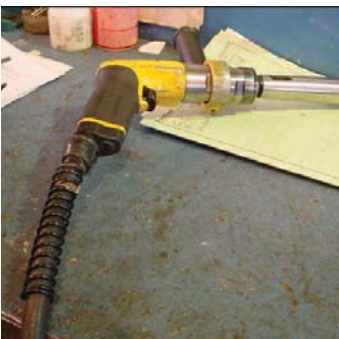
Der Schlauchschutz am Anschluss der Druckluftschrauber verhindert ein brechen und vorzeitigen Verschleiß von Druckluftschläuchen
