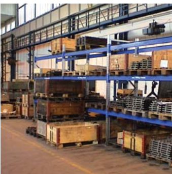
neue Regale mit Durchschubschutz
