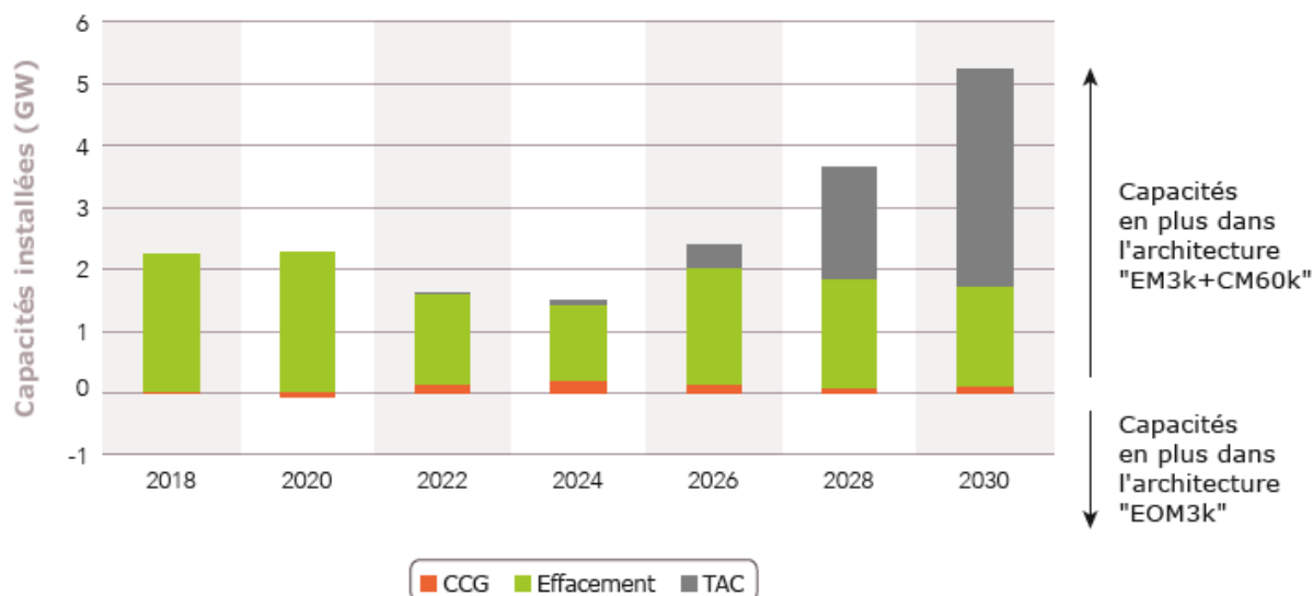
Figure 1. Evolution de la capacité installée sur l'horizon 2018 – 2030 dans un scénario avec mécanisme de capacité et dans un scénario sans mécanisme de capacité (Source: RTE – Etude « Analyse d'impact du mécanisme de capacité: Une contribution au débat européen pour un approvisionnement sûr en électricité », janvier 2018)
